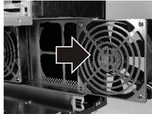
Montage du ventilateur avec le kit sans outil et anti-vibration. Faites glisser vers l'extérieur pour le retirer.
