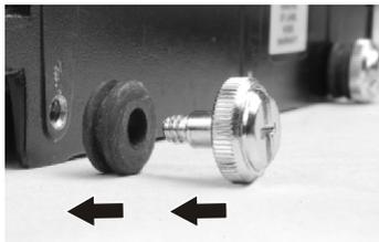
1. Serrez les vis du lecteur de disque dur avec les rondelles en caoutchouc anti-vibration sur le lecteur de disque dur.
